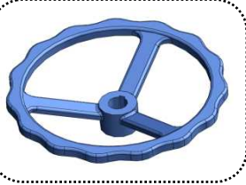
Volan, Vanayı açma, kapamaya yarayan el çarkıdır.
